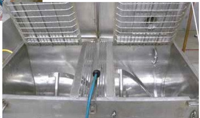
洗浄後のリボンブレンダー
