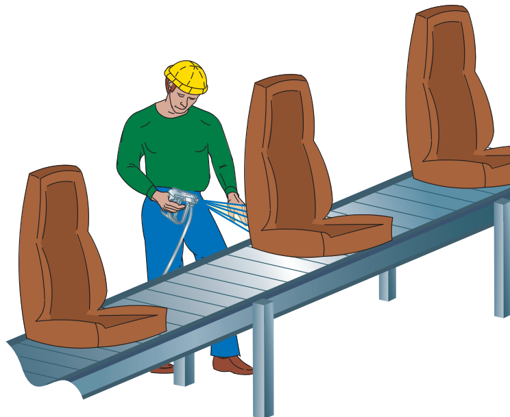
自動車のシートの背、スポンジ、布の取り付け工程で使用されるGunJetスプレーガン
