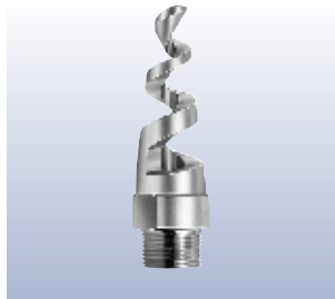
ネジ式 / 二面スパナ掛け 鑄造316ステンレススチール 3/8"~2"BSPTまたはNPT接続 (オスネジ)
