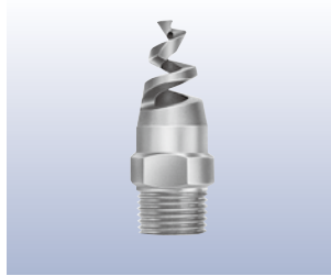
ネジ式 / 二面スパナ掛け 鑄造316ステンレススチール 1/4"~4"BSPTまたはNPT接続 (オスネジ)
