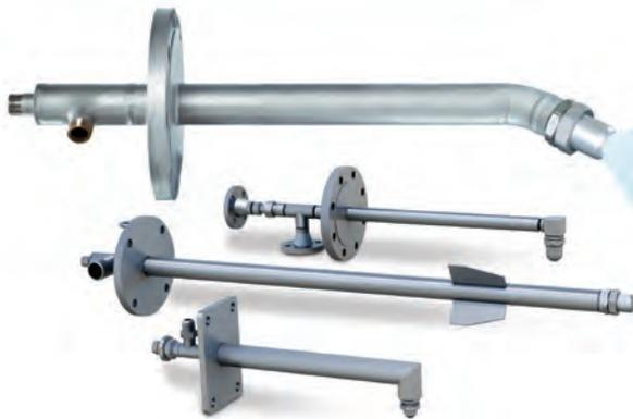
**렌스 및 인젝터.** 당사는 스프레이 인젝터의 전체 제품 라인을 제공합니다. 당사의 표준 경량 FloMax 인젝터는 옵션 사항인 어댑터, 냉각 재킷, 퍼지 튜브 및 보호 튜브가 있는 퀵-릴리스 또는 볼트-온 플랜지의 0°, 45° 및 90° 구성으로 쉽게 사용할 수 있습니다.
