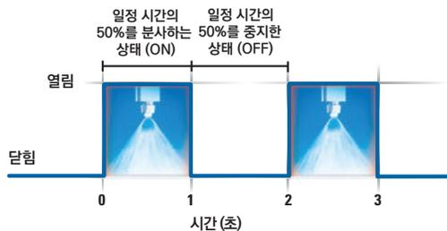
정밀 스프레이 제어(PSC)는 유량을 조절하기 위해 노즐을 매우 신속하게 On/Off 전환하는 작업을 수반합니다. 이 사이클은 매우 빨라서 유량이 거의 일정한 것처럼 보입니다. 일반 노즐의 경우, 유량 조절시 액체 압력의 변화가 필요하며, 이는 노즐의 스프레이 각도/커버리지 및 입자 크기를 변화시킵니다. PSC를 사용하면 압력이 일정하게 유지되어 스프레이 성능의 변화 없이 유량을 바꿀 수 있습니다. PSC는 전기-구동식 스프레이 노즐과 AutoJet 스프레이 컨트롤러를 사용해야 합니다.
