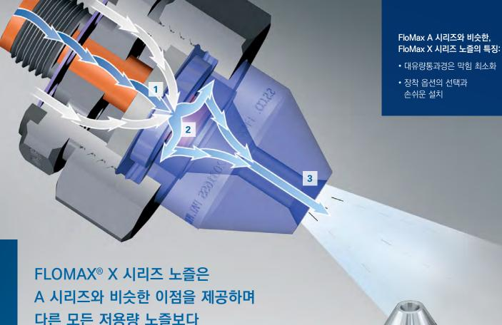
다단 크로스-홀(Cross-Hole) 노즐 설계는 고속 에어 흐름과 혼합하기 전에 액체를 전단하여 우수한 미세분무를 제공합니다. 이것은 다른 노즐보다 낮은 작동 압력에서 작은 입자를 산출하고 입자 크기를 엄격하게 제어합니다. 압축 공기 사용이 감소하고, 더 작은 컴프레서를 사용할 수 있으며, 컴프레서 수명이 연장됩니다.
