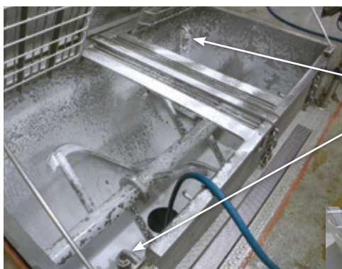
Mezcladora de cinta siendo lavada
