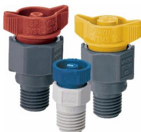
ProMax QuickJet ノズルはクイックコネクトデザインを搭載し、保守時間と運営費の削減を実現。スプレーチップは素早く手で取り付け・取り外しができ、簡単にスプレーパターンの位置決めができるようになっています。
