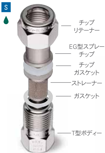
EG型スプレーチップ+11430型アセンブリー ガスケット、スクリーンストレーナー、チップガスケット、 高圧チップリテーナーと共に使用。
