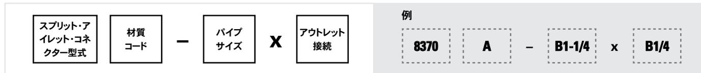
BSPTにはインレット接続の前に“B”をつけます。BSPTのネジ寸法は、日本国内のPTおよびRの規格に相当します。日本国内でご使用の場合は“B”を含めたインレット接続にてお求めください。
