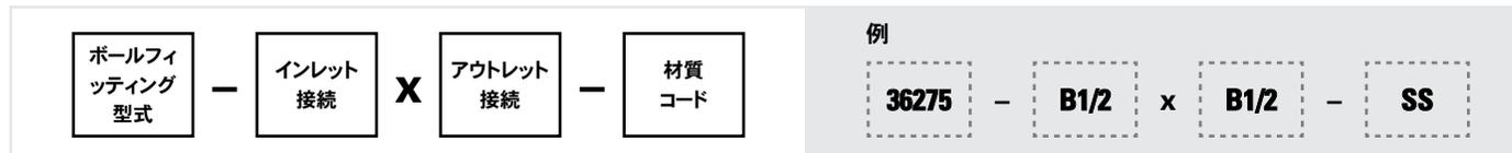
BSPTにはインレット接続の前に“B”をつけます。BSPTのネジ寸法は、日本国内のPTおよびRの規格に相当します。日本国内でご使用の場合は“B”を含めたインレット接続にてお求めください。
