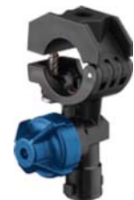
Quick UniJet 다이아프램 체크 밸브 노즐 바디 최대 압력 20 bar (300 psi) 1/2", 3/4" 또는 1" 파이프에 맞춤
