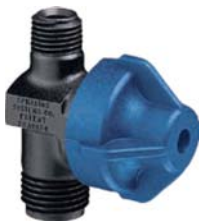
UniJet 다이아프램 체크 밸브 노즐 바디 최대 압력 9 bar (125 psi) 1/4" 또는 1/8" NPT 또는 BSPT (M)
