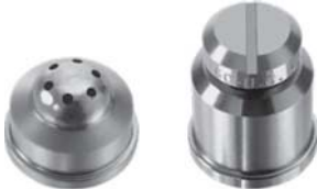
광각 원형 스프레이와 360° 원고리형 스프레이 에어캡은 중공원형, 광각 원형 스프레이와 360° 원고리형 스프레이 패턴을 산출한다.
