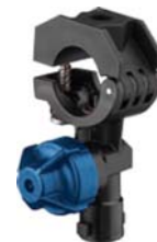
Quick UniJet 다이아프램 체크 밸브 노즐 바디 최대 압력 20 bar (300 psi) 1/2", 3/4" 또는 1" 파이프에 맞춤
