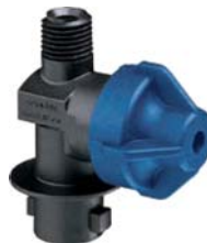
Quick UniJet 다이아프램 체크 밸브 노즐 바디 20 bar (300 psi) 의 최대 압력 1/4" NPT 또는 BSPT (M)
