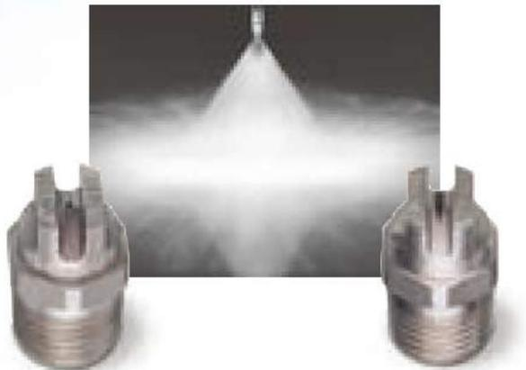
**WashJet® 스프레이 노즐(왼쪽)**은 강력한 세척 성능을 제공합니다. 이 노즐은 고 충격 스프레이를 생성하며, 최대 작동 압력이 207bar (3000psi)입니다. 테이퍼-엣지 부채꼴 스프레이 패턴의 **VeeJet® 노즐(오른쪽)**은 일반적으로 스프레이 헤더에 설치됩니다. 중첩되는 스프레이 분포는 균일한 커버리지를 제공합니다. 해당 어플리케이션에서는 전체 강판이 헤더 아래를 통과하면서 꼼꼼하게 세척됩니다.
