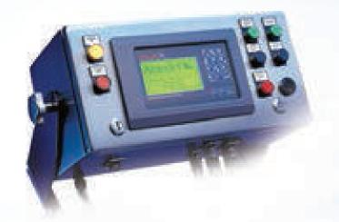
AutoJet 모델 2250 스프레이 컨트롤러는 이형제의 일관된 도포를 유지하기 위해 액체 압력 및 미세분무 에어 압력의 폐-루프 제어를 제공합니다. 스프레이 타이밍은 금형 판의 존재를 감지하는 근접 센서에 의해 트리거됩니다.
