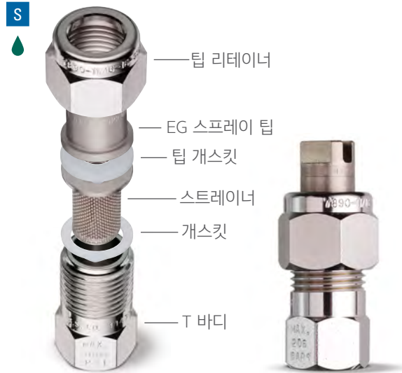
EG 스프레이 팁 + 11430 어셈블리 개스킷, 스크린 스트레이너, 팁 개스킷 및 고압 팁 리테이너와 함께 사용
