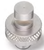
QSTK 스프레이 팁 미니어처 버전 40 psi에서 1 gpm 이하의 유량 (2.8 bar에서 3.9 lpm) 썬 및 QJJS 바디와 함께 사용
